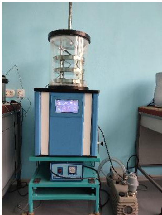
Рисунок 8. Лиофильная сушилка лабораторная TFD-8501, ilShinbiobase Co.Ltd, Корея
